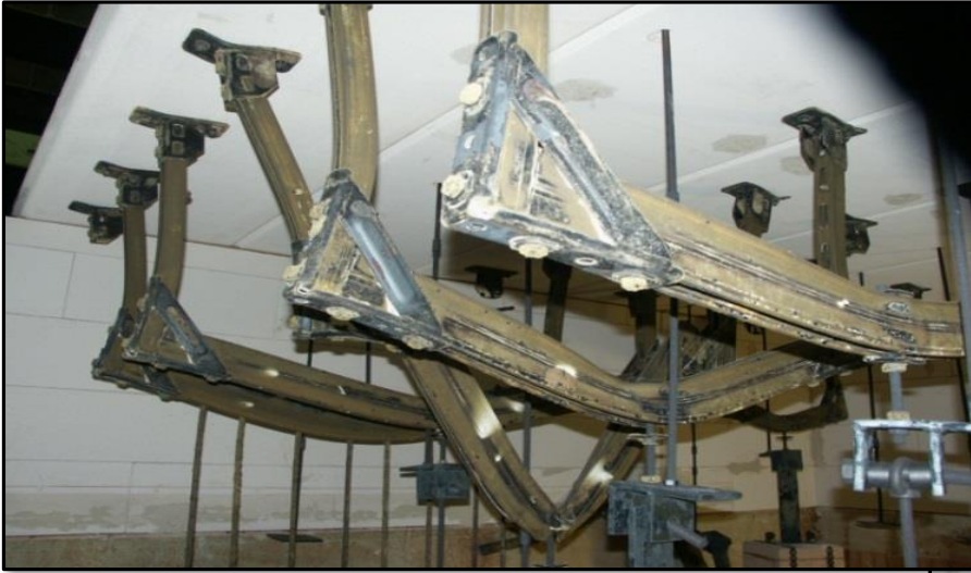
A rendszerek nagymértékű deformációja a terhelés típusától és mennyiségétől függően
