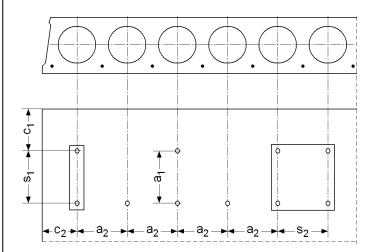
Distance au bord  $c_{min} \ge 100 \text{ mm}$
