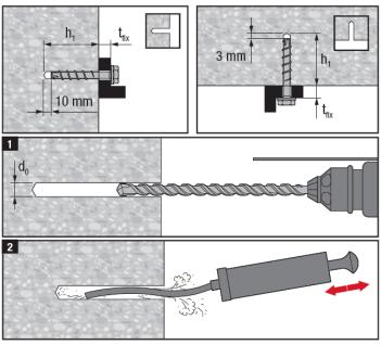
Le nettoyage du trou n'est pas nécessaire après 3 aller-retours) si l'une des conditions suivantes est remplie :
