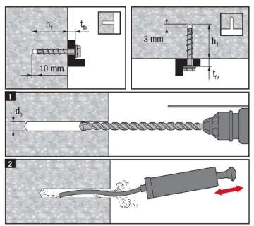
Das Bohrloch ist zu reinigen.
