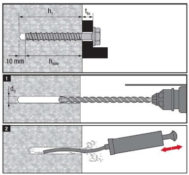
Das Bohrloch ist zu reinigen.
