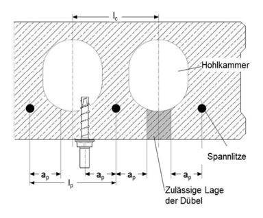
Abstand zwischen den  $I_c \ge 100 \text{ mm}$ Hohlraumachsen  $I_p \ge 100 \text{ mm}$
